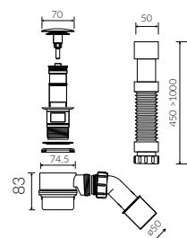
zakres pozycjonowania rur odpływowych / range of positioning of drainage pipes
